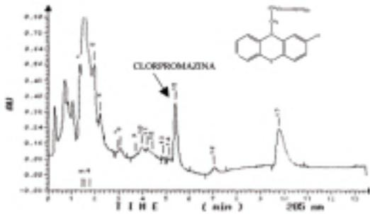
Fig. A - Cromatogramma di un campione contenente Clorpromazina e risultato positivo al test EMIT II Plus
